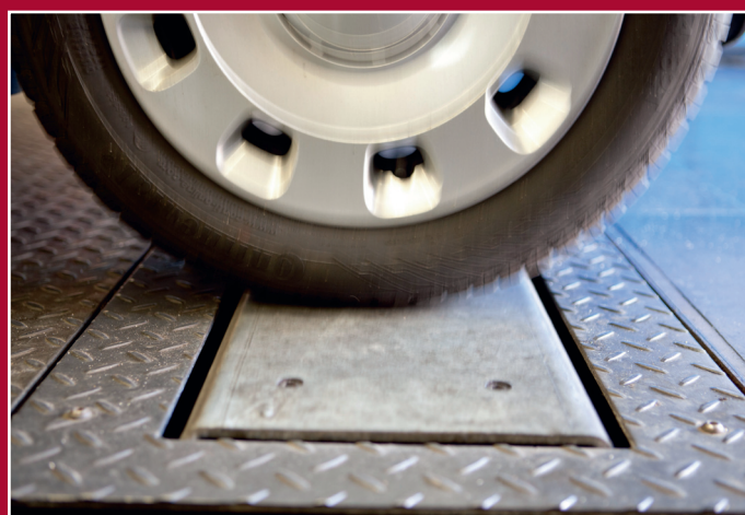
De platen van de Beissbarth-tester doorlopen het Eusama-frequentiegebied.
