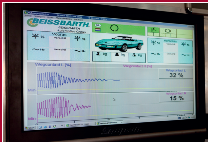
Slechte resultaten op de Beissbarth voor de grijze BMW. De dempers van deze auto stonden al op de nominatie om vervangen te worden. Overigens hanteert Beissbarth het volgende beoordelings-belletje: 0-19% 'slecht'; 20-32% 'onvoldoende'; 40-59% 'voldoende'; 60-99% 'goed'.
