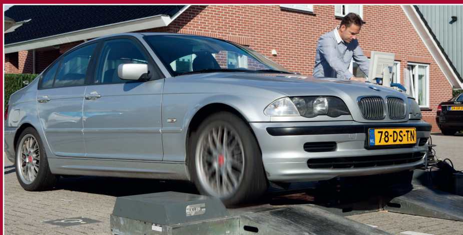
De testbank van Actia Muller, speciaal voor de test op het voorterrein van Autobedrijf Hulst geïnstalleerd.
