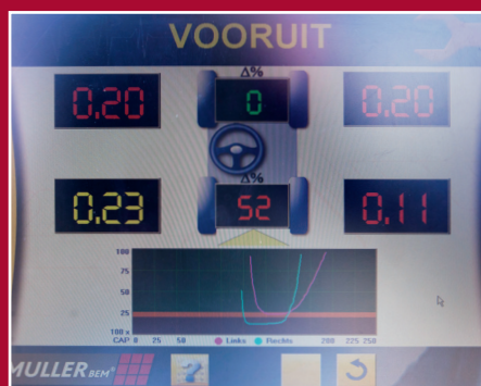
De BMW valt door de mand op de Actia Muller-bank. De dempers voor zitten met 20% op de Eusama-ondergrens. De 0,23 links-achter schrijft Actia Muller in geel, twijfelgevalletje en de 0,11 rechtsachter is dieprood. Het verschil links rechts staat voor in groen (0%) en achter in rood (52%)
