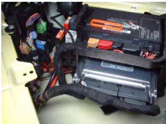
2 Stecker lösen. Dazu links und rechts die Griffe nach außen ziehen. Zieht man kräftig genug, lösen sich auch die Stecker mit ab.
